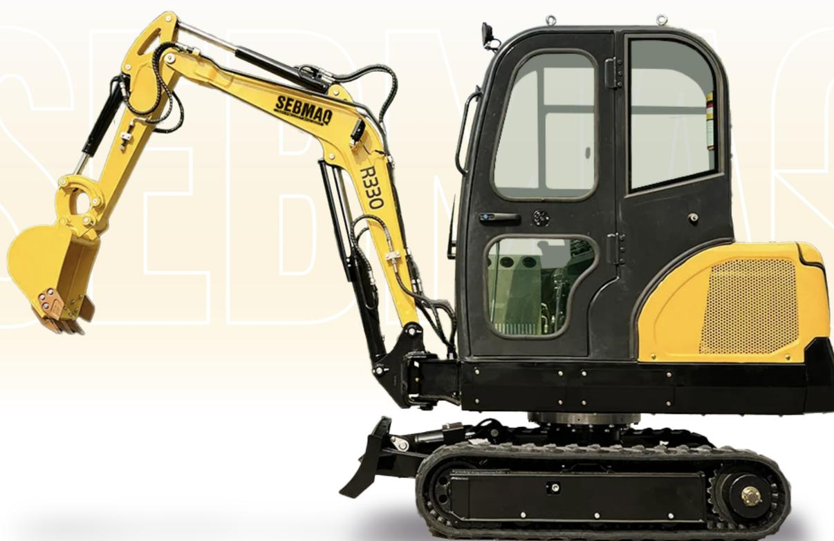
La Miniexcavadora K25 con motor Kubota y tecnología alemana de alta calidad, está diseñada para trabajos medianos y pequeños. Equipada con aire acondicionado, ofrece comodidad en todas las condiciones climáticas. Su brazo oscilante permite trabajar en terrenos inaccesibles para maquinaria grande. Compacta, fácil de operar y de trasladar, es ideal para empresas y particulares que buscan versatilidad.
