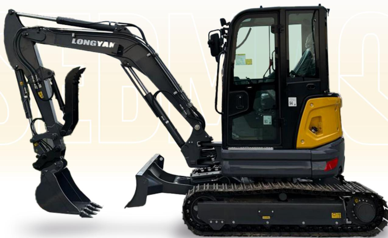
La excavadora CDM6035 de la marca LONGYAN, equipada con un motor Kubota de 25 Hp, ofrece alta eficiencia y confiabilidad en las labores diarias. Su potencia facilita las tareas, haciéndolas sencillas para el operador. La cabina vidriada y ergonómica brinda una vista de 360° y garantiza una experiencia de manejo cómoda y placentera para cualquier jornada de trabajo.
